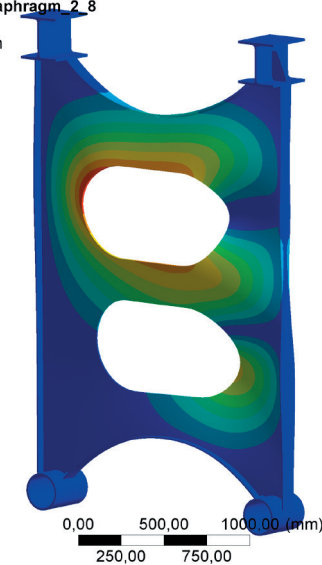
Beulfigur aus der linearen Beulanalyse
